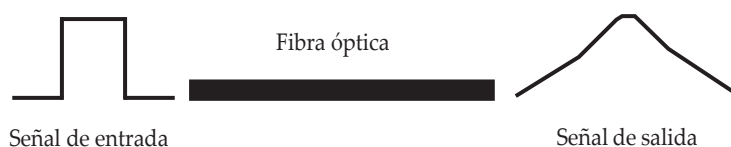
Figura 11. Dispersión o ensanchamiento de los pulsos digitales de entrada
